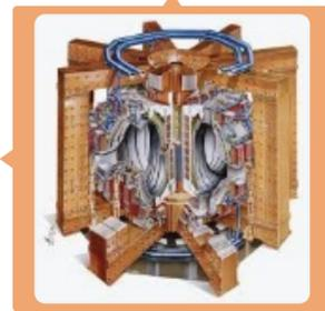
Nel TOKAMAK, macchina ad uso ancora sperimentale, vengono miscelati gli isotopi gassosi dell'idrogeno (deuterio e trizio). Questi elementi vengono riscaldati fino a diventare **plasma**. Potenti campi elettromagnetici creano le condizioni affinché gli isotopi dell'idrogeno finiscano per fondersi, formando un atomo di elio
