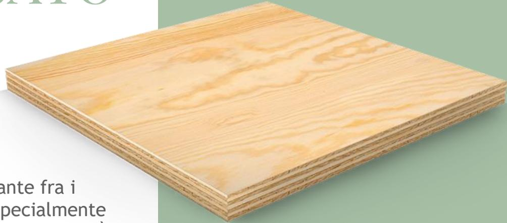
Il compensato è il più importante fra i semilavorati di legno, usato specialmente nella produzione di mobili e di pannelli. È costituito da tre (più raramente cinque) fogli sottili di legno, incollati uno sull'altro, con le fibre disposte perpendicolarmente in modo da irrobustire l'insieme: a parità di spessore, il compensato è molto più resistente, e anche più flessibile, del legno naturale.
