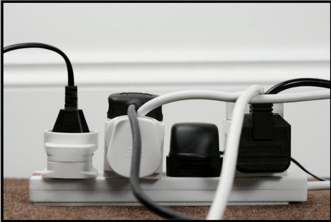
*Questo tipo di guasto si verifica quando l'intensità di corrente supera un valore prefissato ad esempio per troppi apparecchi accesi contemporaneamente.*
