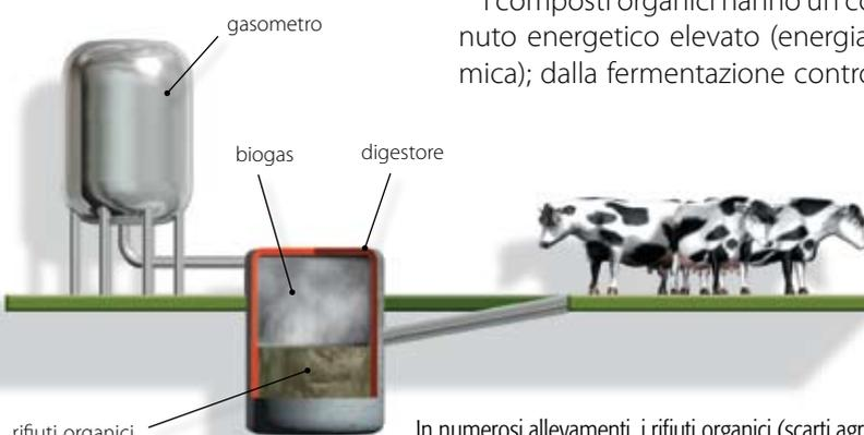
In numerosi allevamenti, i rifiuti organici (scarti agricoli, letame) vengono convogliati in grossi recipienti (digestori) e qui fermentati dai microrganismi anaerobi. I gas prodotti vengono raccolti nel gasometro per essere poi utilizzati per il riscaldamento, come carburante ecc.
