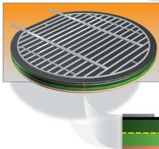
Schema di cella fotovoltaica: è una specie di pila costituita da elementi di silicio, che, quando è investita dai raggi solari, produce una debole corrente elettrica.
